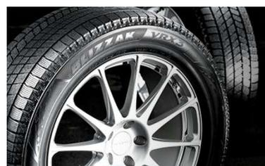
率No.1は「ブリザック」(ブリヂストン)です。一般ドライバー装着率47.0%、タクシー装着率81.6%というのも製品の信頼性が高い証拠かもしれません。ところで、なぜ冰雪上でタイヤがすべらないのか？ホームページによると、①フレキシブル発泡ゴムの親水作用および毛細管現象による吸水力とロングステイブルポリマー配合により、経年によるグリップ性能低下の抑制そして②水流の動きをコントロールする溝(パターン)の進化と接地圧を均一に保つブロック配置が理由だそうです。
